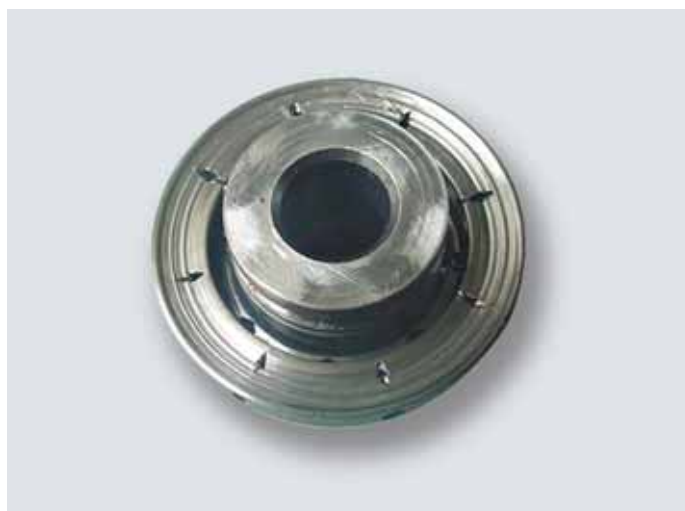
Desgaste por causa del rozamiento entre el collar y frente del plato.
