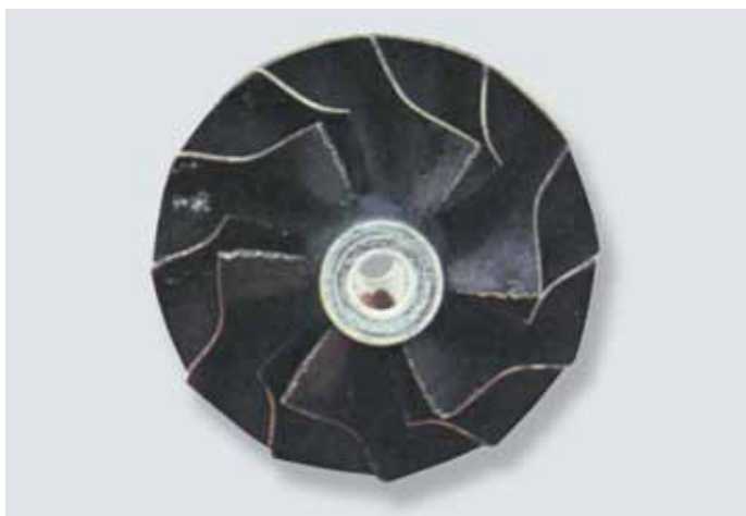
fig. 4.17 ingestión del polvo a causa de no hacer uso del filtro de aire
