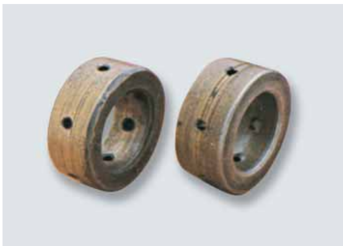
fig. 4.9 Cojinetes radiales dañados por causa del aceite contaminado
