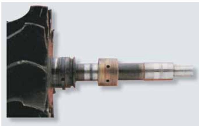
fig. 4.7 eje y cojinetes radiales rallados a causa de la presencia aceite lubricante contaminado
