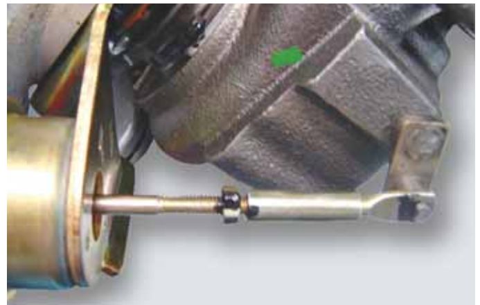
Ejemplo de rotura del lacre de la tuerca de ajuste del vástago del actuador
