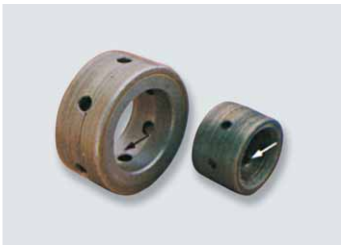
fig. 4.10 aceite contaminado también puede dañar el diámetro interno de las cojinetes.
