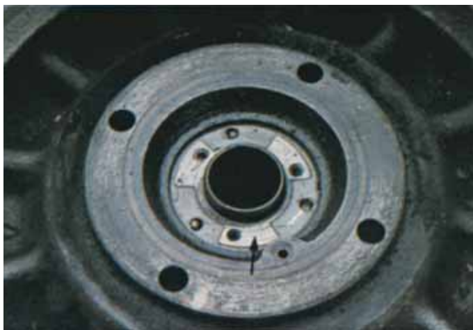
fig. 4.12 cojinete de apoyo del plato dañado por el aceite contaminado
