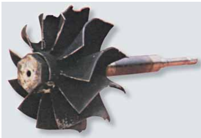
fig. 4.13 rotor de la turbina dañado por el objeto extraño
