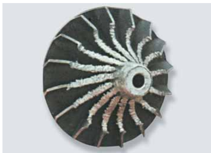
fig. 4.16 ejemplo típico de ingestión de objeto extraño como una tuerca, arandela, etc,
