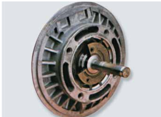
fig. 4.4 rotura del eje debido a la falta de aceite
