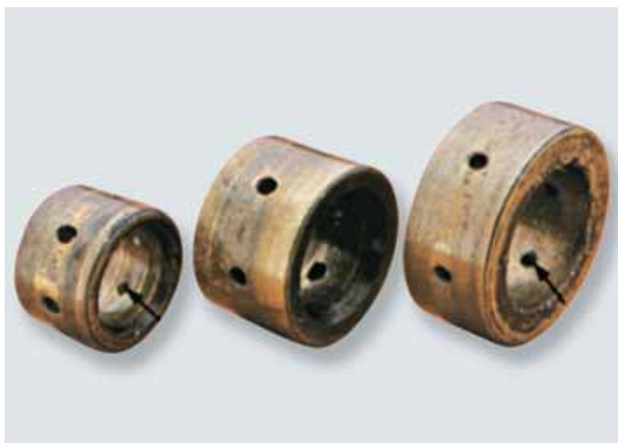
fig 4.3 cojinete radial con los agujeros de pasaje de aceite obstruido
