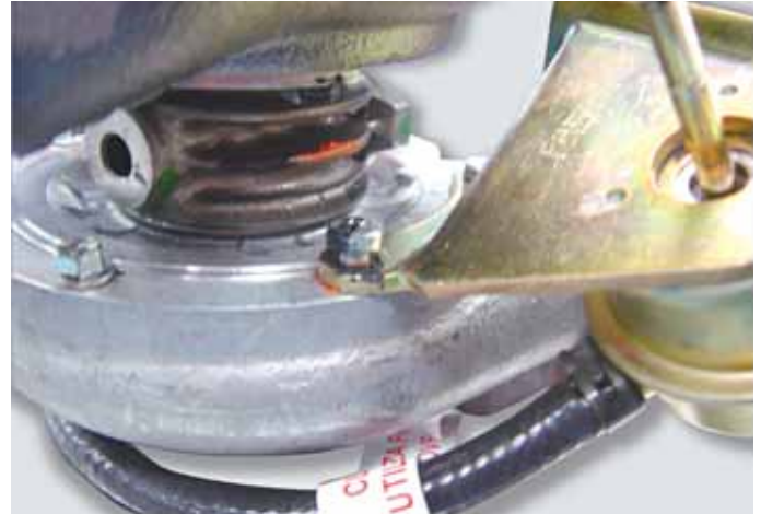
Alteración del tornillo de fijación del Apoyo del Actuador
