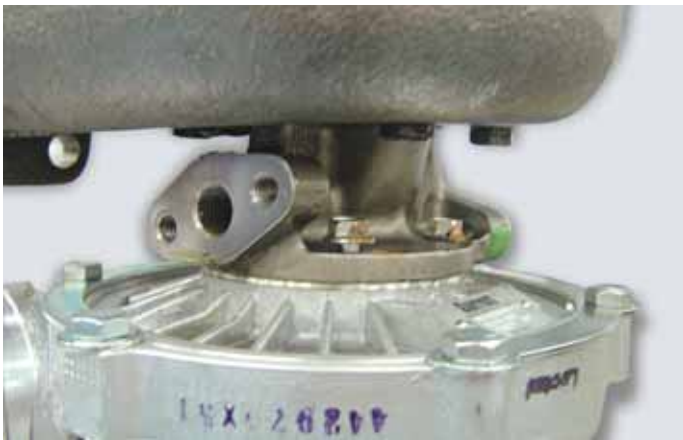
Alteracion del tornillo de fijación de la Carcasa Central en el Plato
