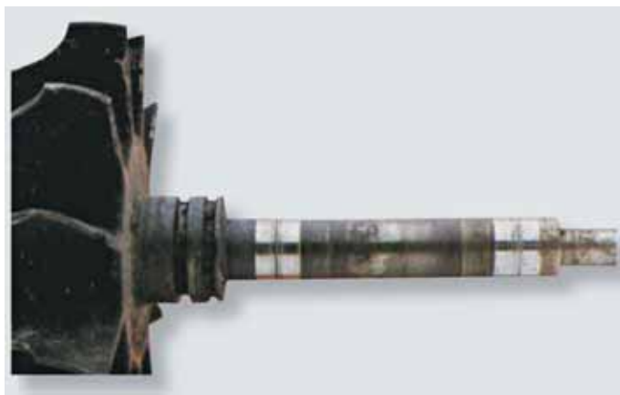
fig. 4.8 Ralladuras profundas en los regazos de los cojinetes causados por el aceite contaminando
