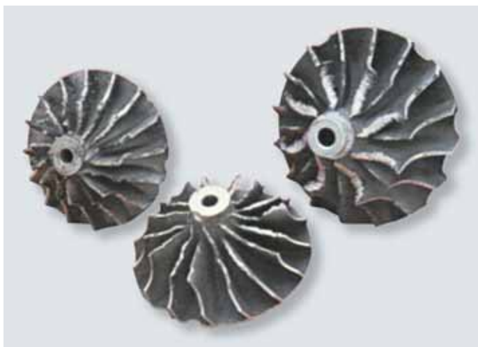
fig. 4.15 ejemplos típicos de ingestión de objeto extraño
