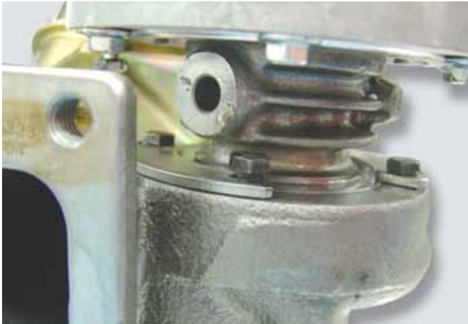
Alteracion del tornillo de fijación de la Carcasa de la Turbina
