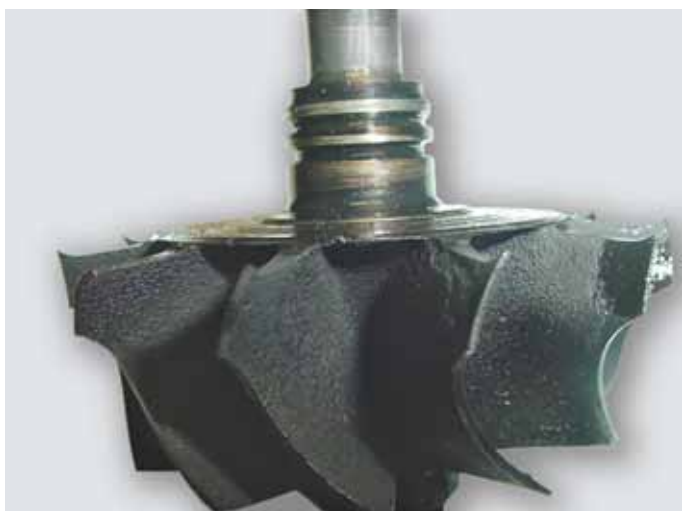
El ejemplo de empuje axial en sentido del compresor de turbina.
