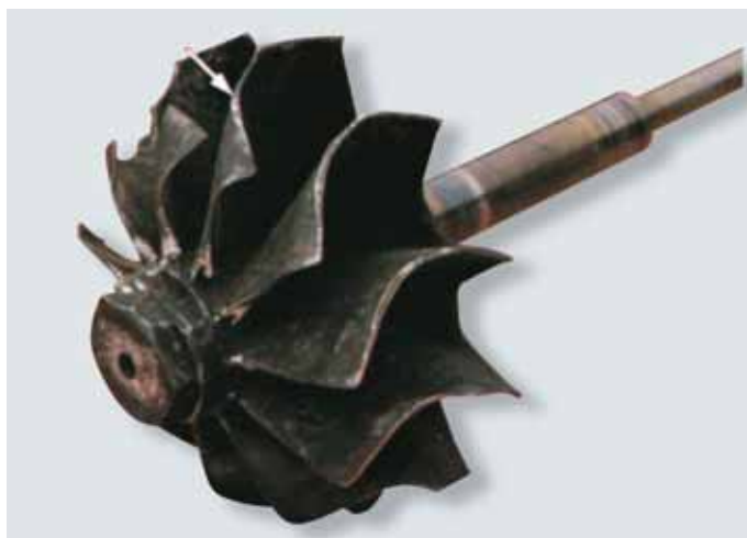
fig 4.5 Roce del rotor de la turbina debido a la falta de aceite
