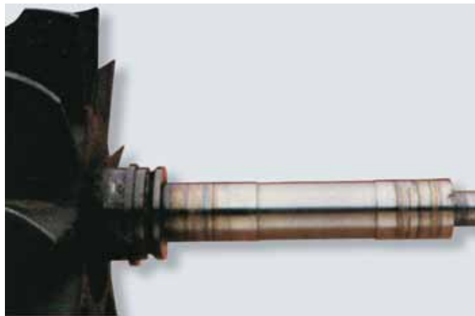
fig. 4.2 deposición del material de la cojinete radial en el eje
