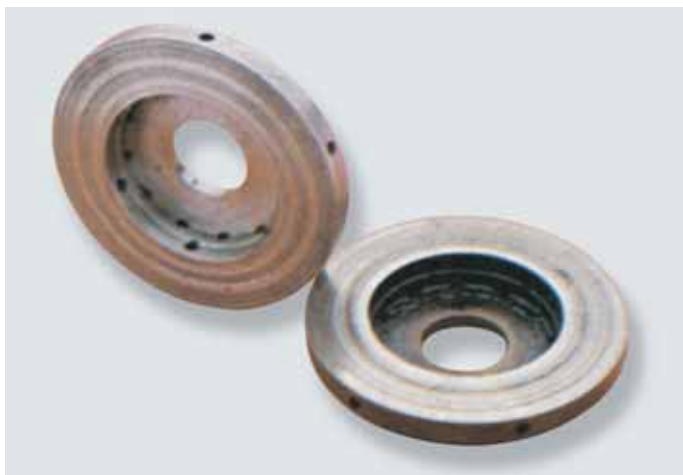
fig. 4.11 collar dañado por trabajar con aceite contaminado
