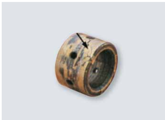
fig. 4.6 Cojinete radial con ralladura debido al sobrecalentamiento
