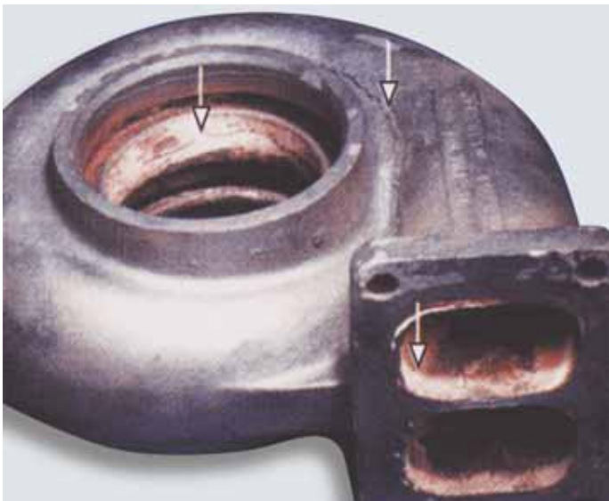
La alta temperatura raja la carcasa de turbina, cambia su color o provoca la rajadura del material en las superficies internas
