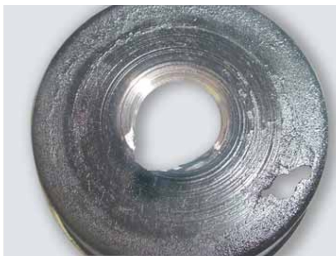
Protección térmica dañada por la fricción con el Rotor de la Turbina causado por el empuje axial. - Exceso de Humo
