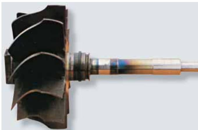
fig. 4.1 azulamiento del eje debido a aumento de temperatura causado por la falta de aceite
